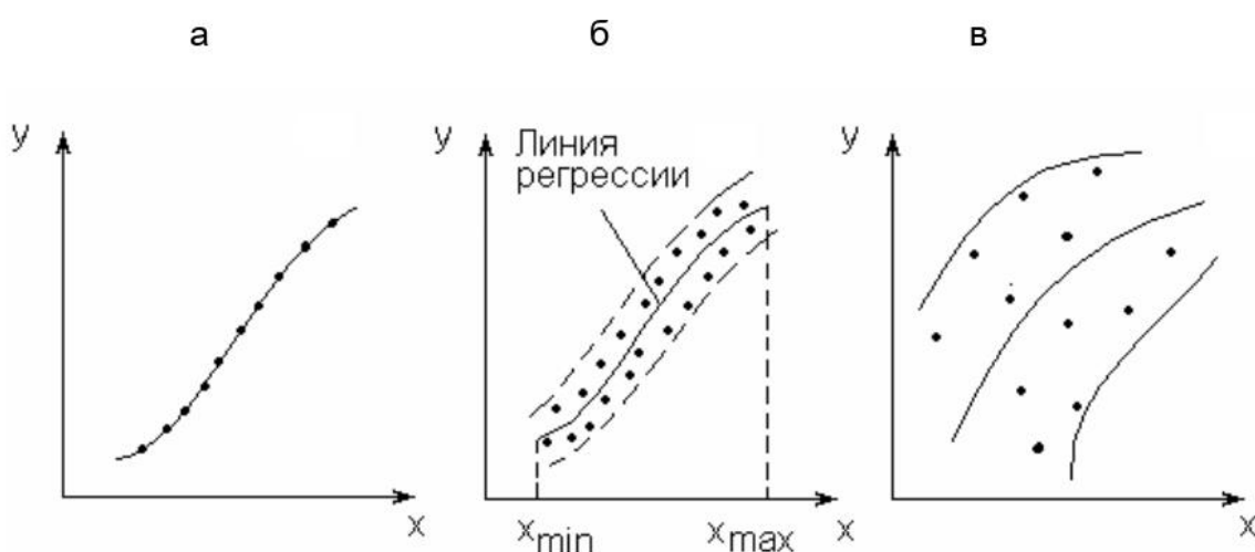
Рис.4.1. Виды связей: а – функциональная связь, все точки лежат на линии; б – связь достаточно тесная, точки группируются возле линии регрессии, но не все они лежат на ней; в – связь слабая
