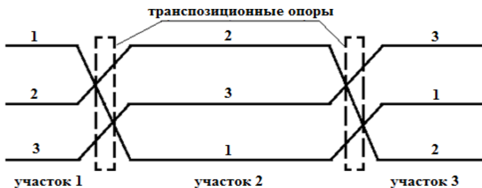
Рис. 3. Схема полного цикла транспозиции участков воздушной линии электропередачи: 1, 2, 3 – фазные провода
