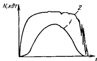
Рис.5. Изменение мощности солнечной энергоустановки в течение дня:
