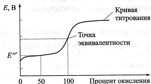
Рис. 13.2. Пример кривой потенциометрического титрования
