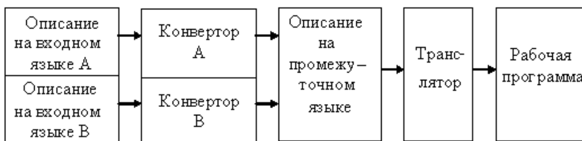
Рисунок 12 - Структура программной системы
