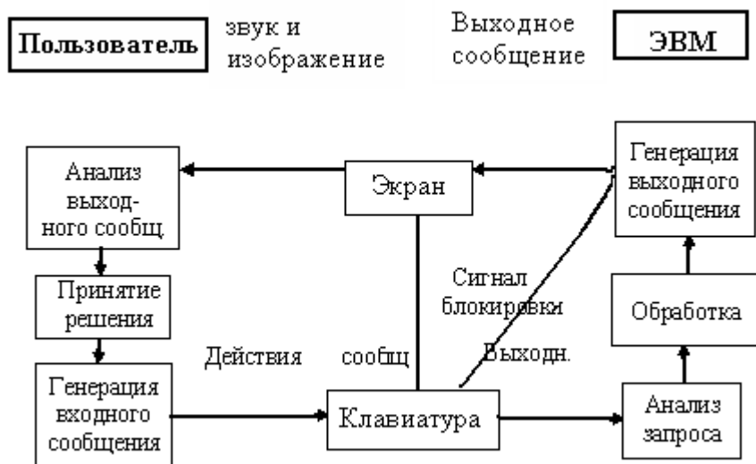
Рисунок 13 - Структурная схема диалогового взаимодействия человека и ЭВМ
