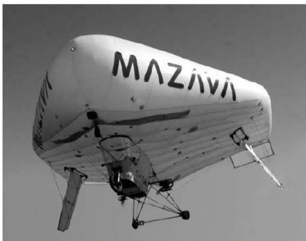
Рис. 4.30. Солнечный дирижабль с гибридным двигателем
