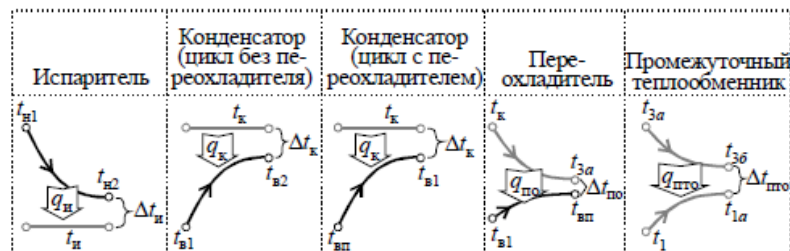
Рис. 19. Температурные схемы теплообменников
