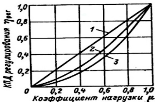
Рис. 4. Зависимость теоретического КПД дроссельного регулирования вентиляторов от коэффициента нагрузки \mu
