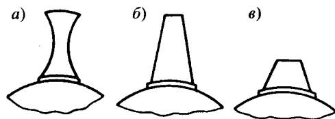
Рис. 8.37. Разновидность кулачков грунтоуплотняющих катков
