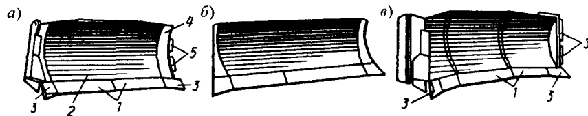
Рис. 8.21. Основные типы отвалов бульдозера: 1 — средние ножи; 2 — лобовой лист; 3 — угловые ножи; 4 — боковые щитки; 5 — боковые ножи
