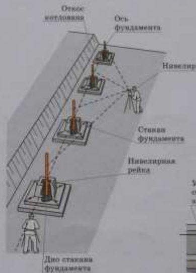
ПРОВЕРКА ОТМЕТКИ ДНА СТАКАНА ФУНДАМЕНТА
