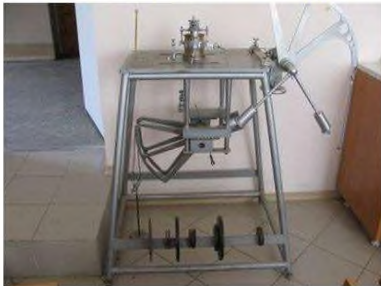
Сдвиговой прибор ПСГ-2м для испытания глинистых грунтов
