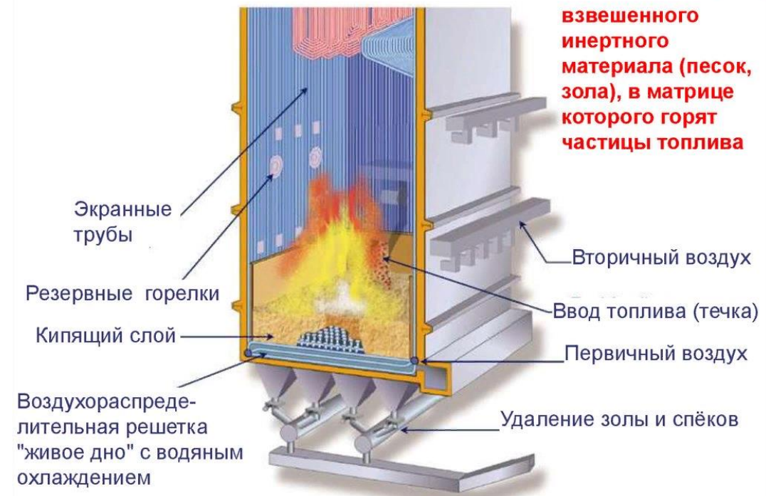
Топка для сжигания твёрдого топлива в кипящем слое (КС)
