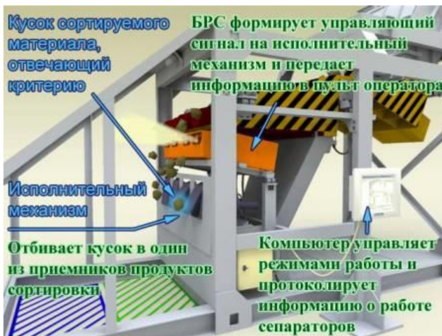
Рис. 4. Блок рентгено радиометрической сепарации (БРС)
