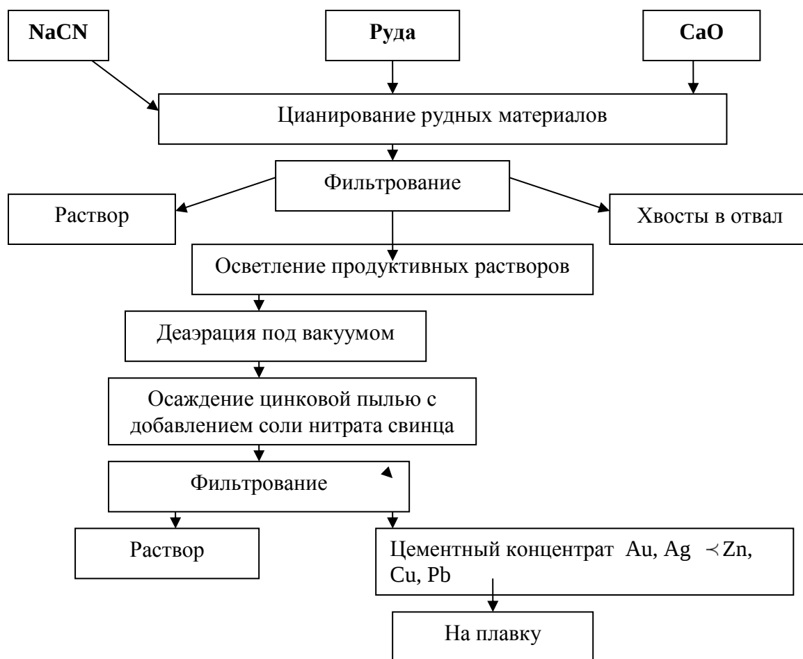
Рис. 4.63. Принципиальная схема цементации золота и серебра цинковой пылью из цианистого раствора [2]
