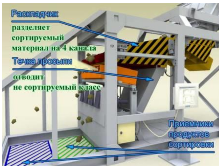
Рис. 5. Разделительное устройство, делящее поток руды на классы
