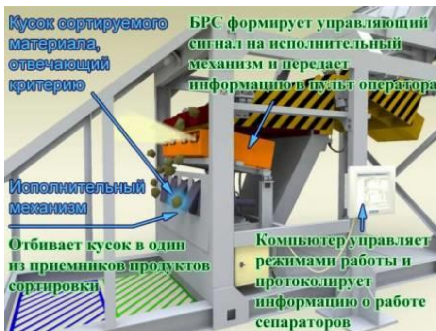
Рис. 4. Блок рентгено радиометрической сепарации (БРС)
