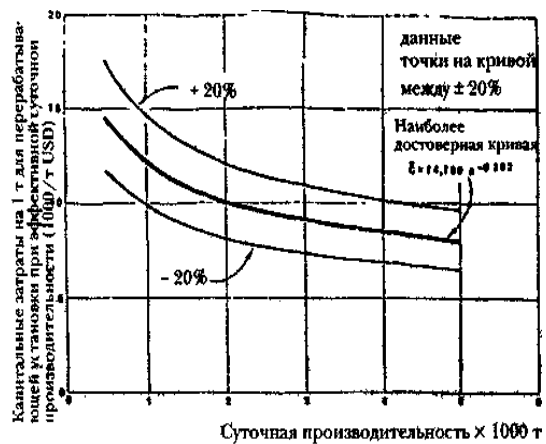
Рис. 6.14. Влияние производительности установки на капитальные затраты при агитационном выщелачивании и
