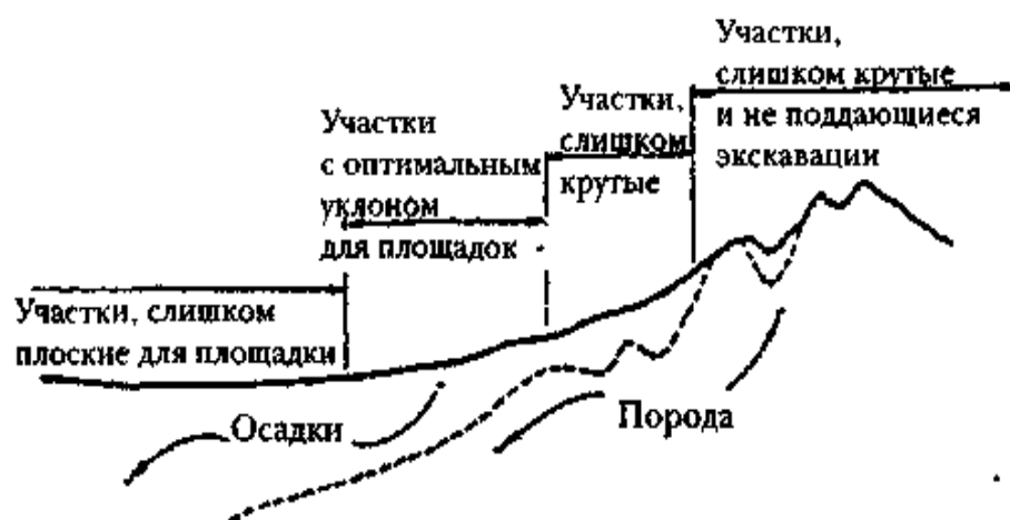
Рис. 4.7. Типовой профиль района и размещение площадок кучного выщелачивания
