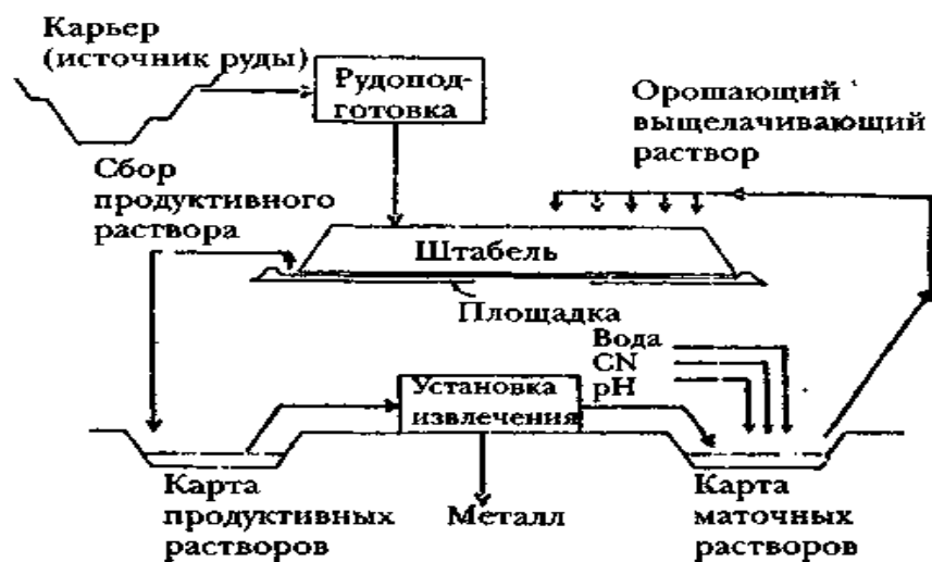
Рис. 4.4. Принципиальная схема кучного выщелачивания
