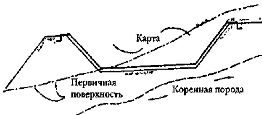
Рис. 4.4.8.а. Типовой разрез участка кучного выщелачивания через карту
