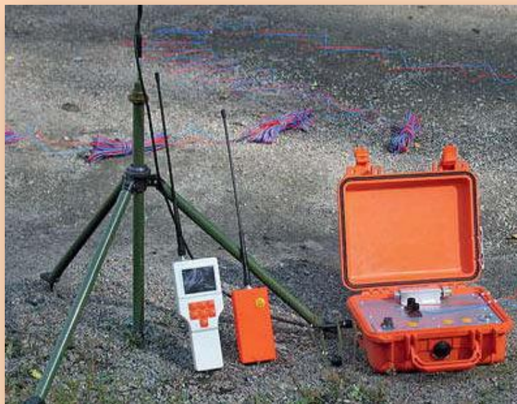
Комплекс аппаратуры дистанционного взрывания по радиоканалу, включающий командный блок, исполнительный блок и ретранслятор.
