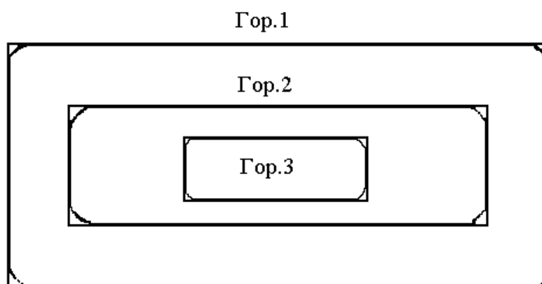
Рис. 3.3а. Построение контура карьера по средней линии горизонта прямоугольной формы
