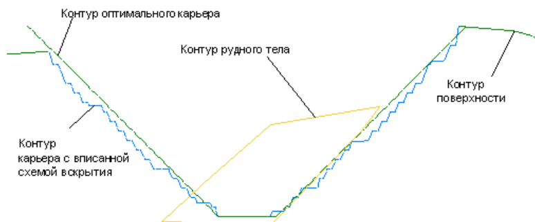
Рис. 3 Разрез рудного тела, поверхности, оптимального карьера и оптимального карьера с вписанной схемой вскрытия
