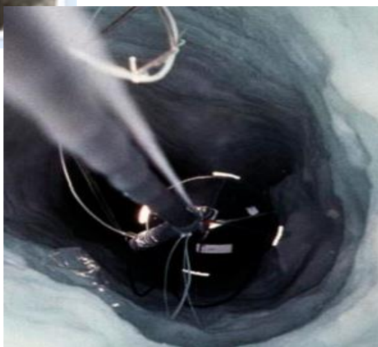
Оценка состояние скважины при помощи телеметрического прибора погружного типа (ПТП-01-13)
