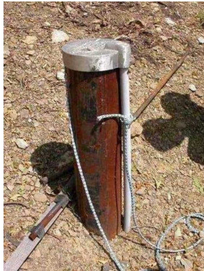
Устье наблюдательной скважины
