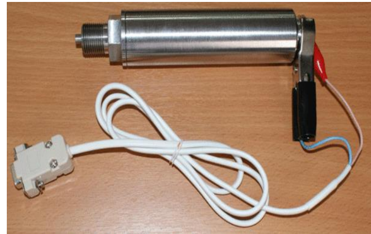
Манометр-термометр автономный устьевой ФОТОН-У - предназначен для диагностических исследований скважин. Прибор позволяет производить измерение значений давления и температуры и регистрацию результатов измерений в энергонезависимой памяти.
