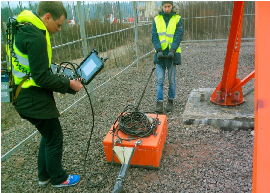
Результаты обследования свайных фундаментов здания методом георадиолокации.
