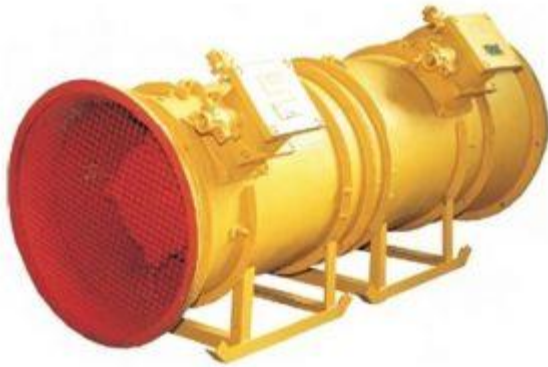
Вентилятор местного проветривания ВВМ-8
