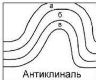
Рис. 1. Виды тектонических деформаций: а-в — горные породы
