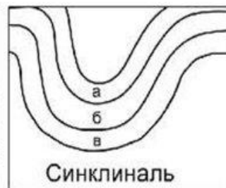
Рис. 1. Виды тектонических деформаций: а-в — горные породы
