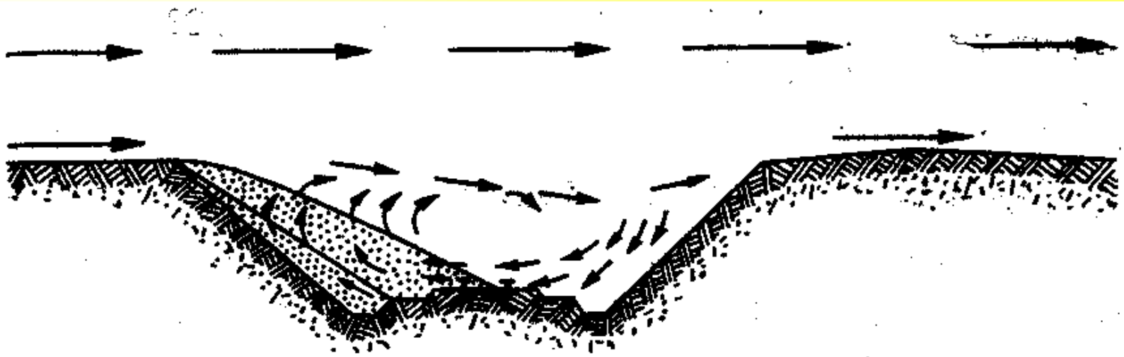
Рис. 13.4. Схема образования песчаных заносов в железнодорожной выемке в Каракумах (по М. П. Петрову)
