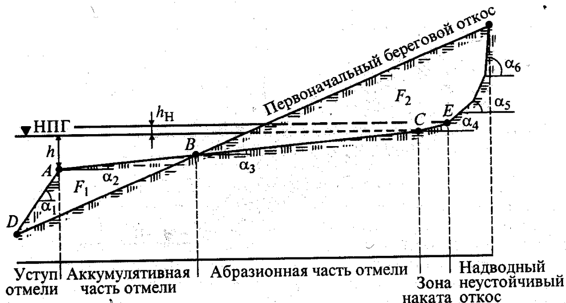
Рис.6. Расчетная схема для прогноза переработки берегов водохранилищ по методу Г.С. Золотарева
