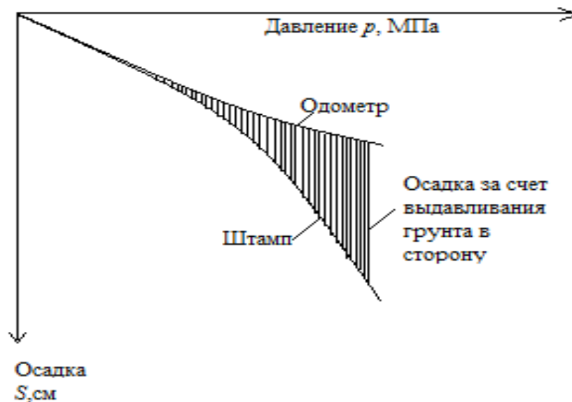
Рис. 4.1. Схема, иллюстрирующая связь между осадкой грунта в одометре и под штампом
