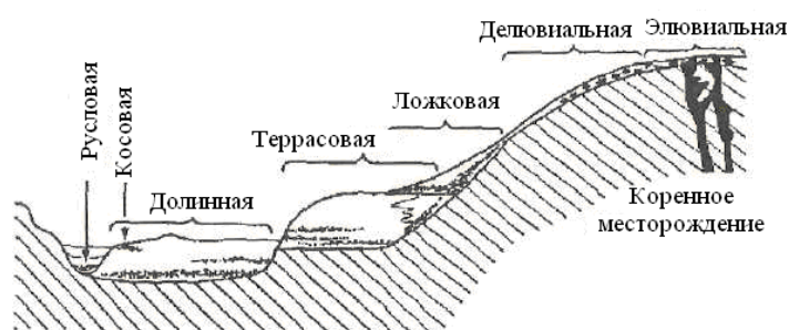
Рис. Схема размещения россыпных месторождений различных видов в поперечном сечении речной долины.
