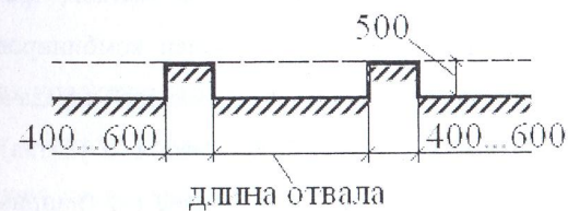
Рис. 3.11. Схема разработки грунта траншейным способом
