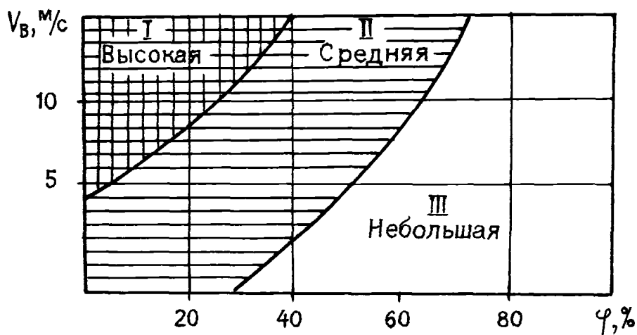
Рис. 2.6. Зависимость скорости распространения пожара от скорости ветра и влажности воздуха
