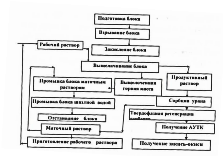
Рис. 37. Технологическая схема подземного выщелачивания скальных урановых руд
