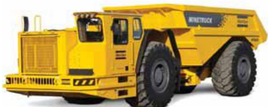
Рис.2.7. Подземный автосамосвал МТ5020, грузоподъемностью 50т компании Atlas Copco
