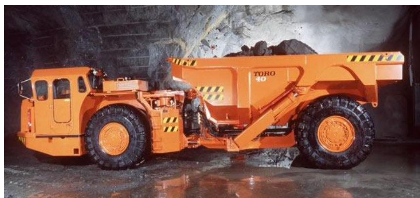
Рис.2.7. Подземный автосамосвал Toro 40, грузоподъемностью 40т компании Sandvik Mining http://mc.sandvik.com
