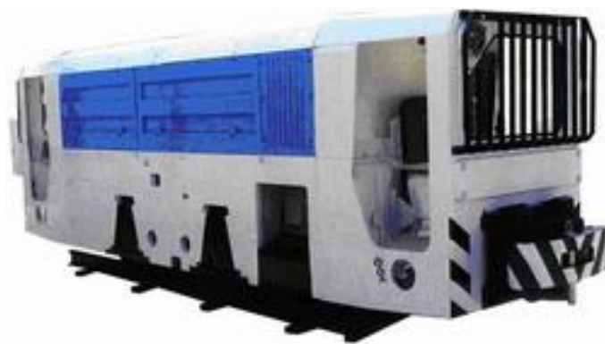
Рис. 1.9. Дизельгидравлический шахтный локомотив DH70D.3
