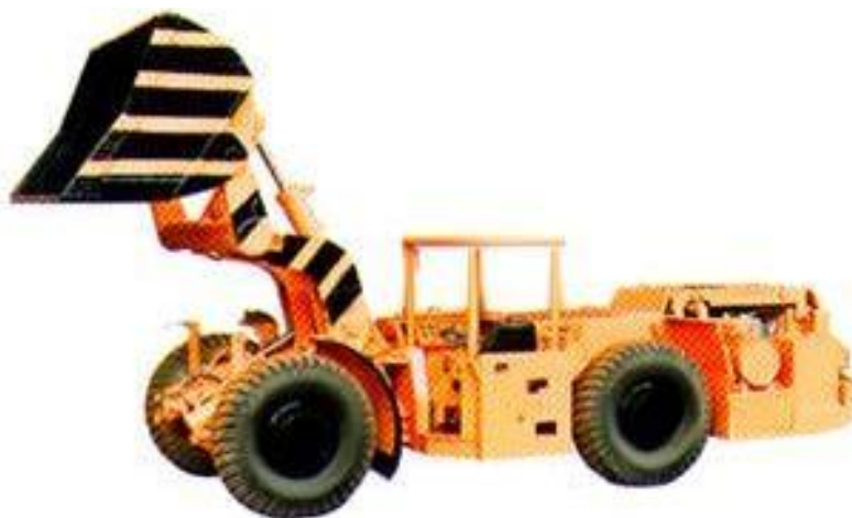
Рис. 2.1. Ковшовая погрузочно-транспортная машина ПД-5А
