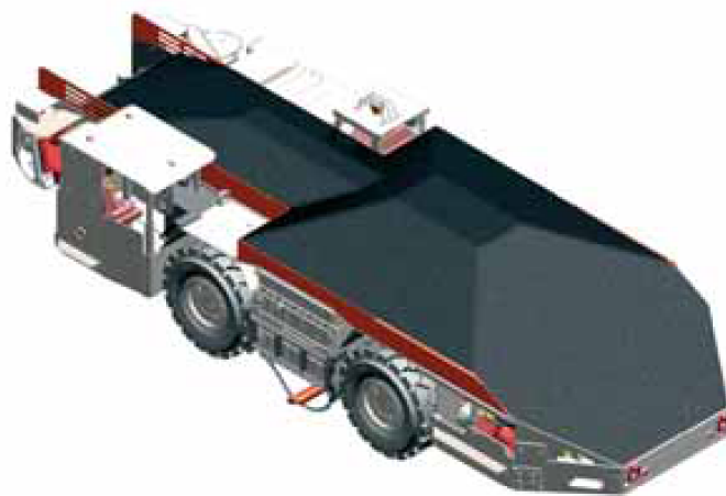
Рис.2.9. Электрический самоходный вагон компании Sandvic TC790
