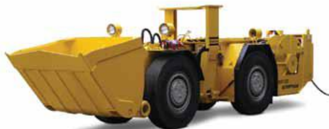
Рис.2.4. Электрический погрузчик Scooptram EST2D компании Atlas Copco
