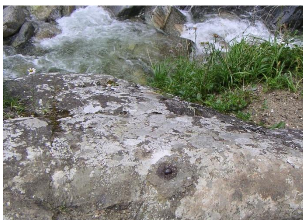
Рис. 7.25. Фото государственного грунтового репера, установленного в горной местности
