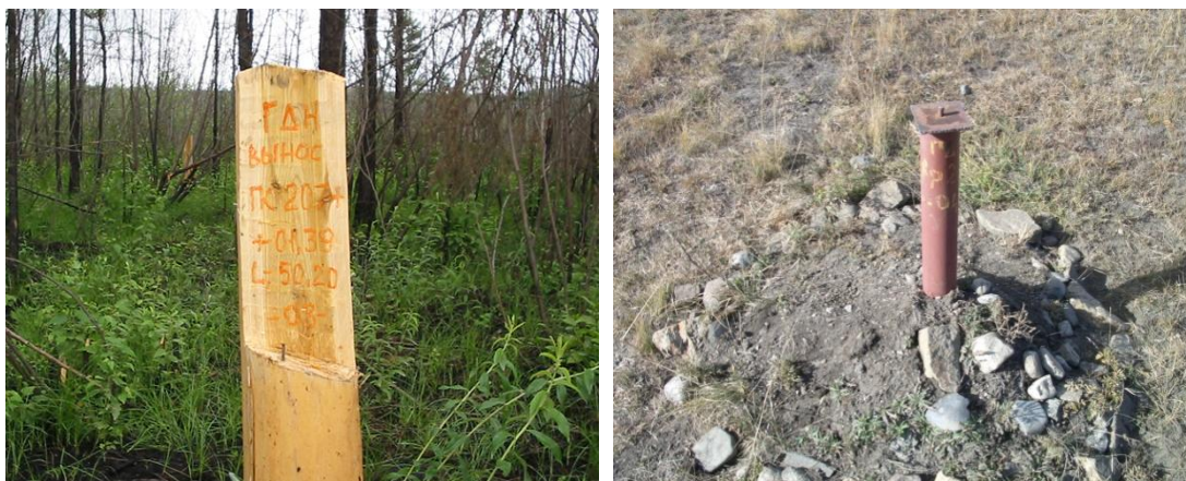
Рис. 7.22. Фото грунтового репера ГДН (установленный институтом ГипроДорНИИ)
