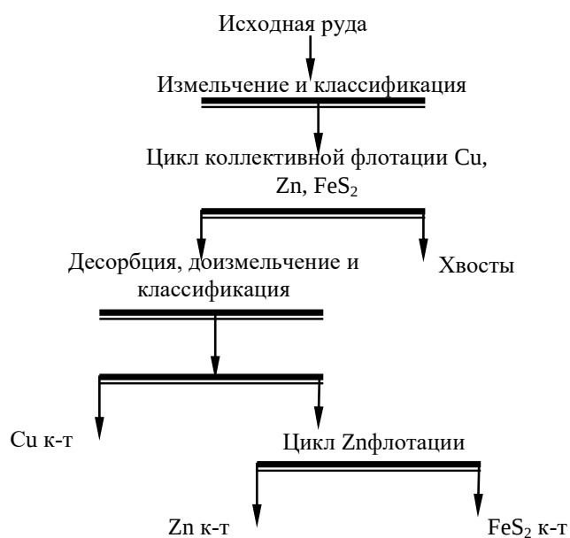
Рис.3.10 Схема коллективной флотации медно-цинковых руд с последующей селекцией
