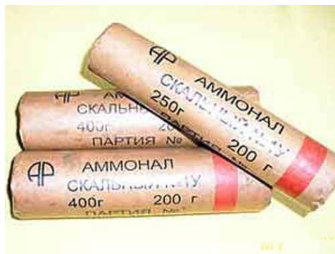
Рис. 15. Патроны аммонала скального
