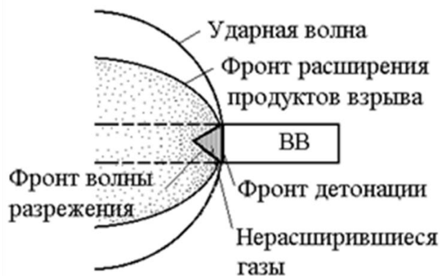
Рис. 9. Схема прохождения детонации по заряду ВВ
