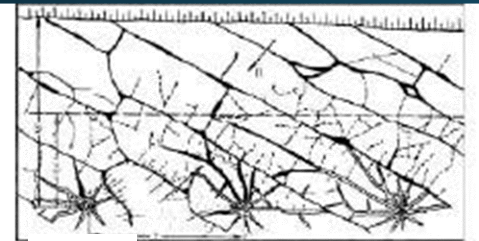
Схема разрушения сильнотрещиноватого массива горных пород при однорядном взрывании.
