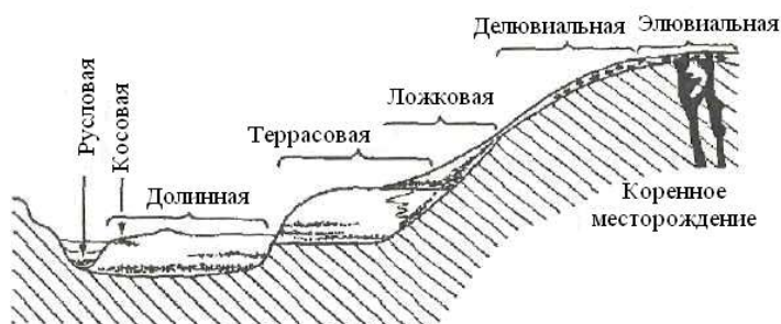
Рис. Схема размещения россыпных месторождений различных видов в поперечном сечении речной долины.
