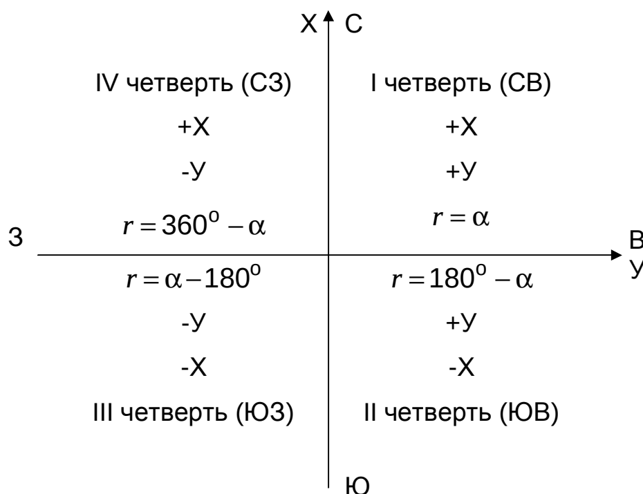
Рис. 1. Зависимость между румбами и дирекционными углами
